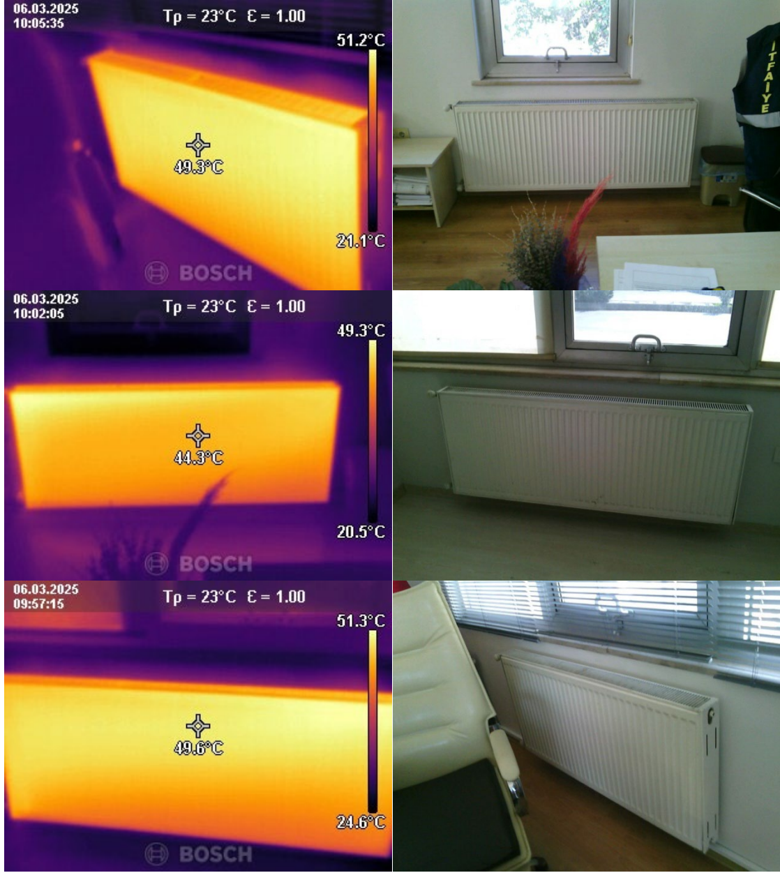
Resim 5.4-3 Radyatör Termal Kamera Ölçüm Görselleri
